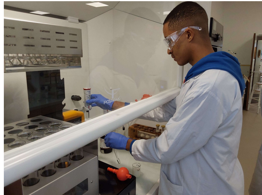
Analyse à l'aide d'un butyromètre de la teneur en lipides des différents yaourts
